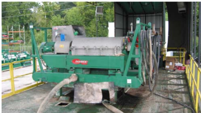
Рис. 3. 14-дюймовая декантерная центрифуга DE-1000 Derrick.
