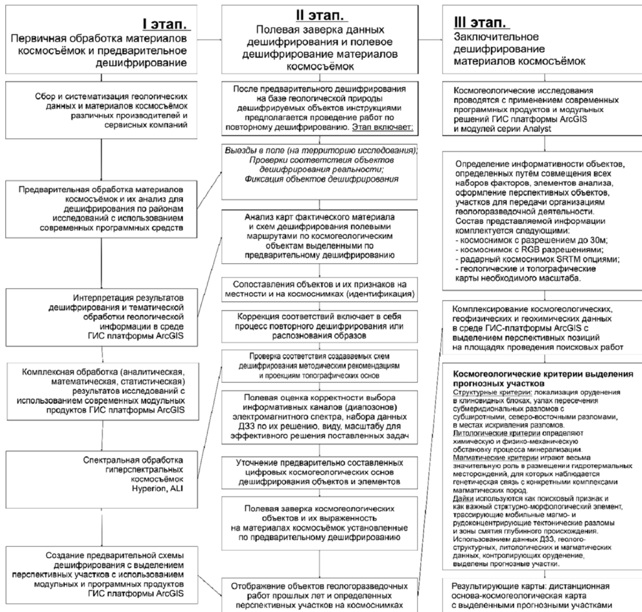
Рис. 1. Схематическая основа космогеологических исследований при прогнозировании перспективных для обнаружения мест скопления полезных ископаемых.
