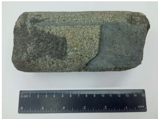
Рис. 1. Образец породы габбро-диабаз скважины № 279 Первомайской площади ПТ с глубины 2022,5 м.
