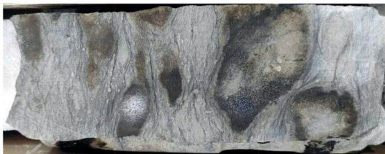
Рис. 3. Брекчированный известняк, верхнетурнейский подъярус, сводовая часть Южно-Татарского свода.
