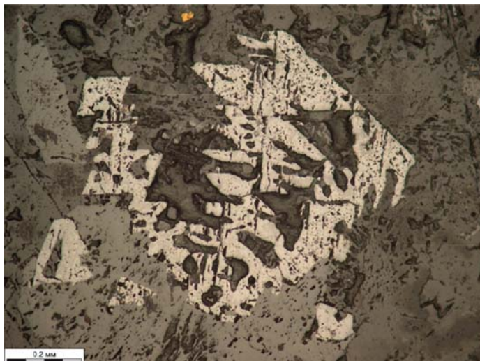
Рис. 2. Специфический рудный минерал: «скелетный» кристалл магнетита в полированном образце габбро-диабазы с глубины 2090,3 м.
