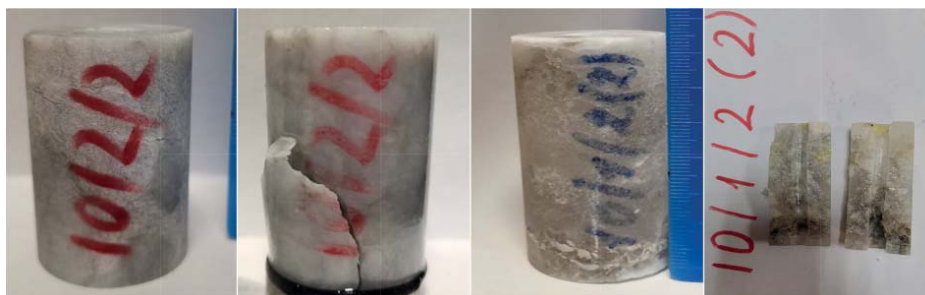
Рис. 7. Фото образцов керн (аргиллит) до и после экспериментов: разрыв маслом ГРП (слева), разрыв БС (справа).
