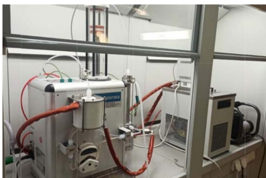
Рис. 3. Фотография элементов установки ПИК ОСГ (операционный, измерительный и термостатируемые блоки).
