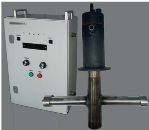
Рис. 1. Лабораторный ультразвуковой генератор TS4M1 в комплекте с испытательным макетом линейной модели пласта Н-1.
