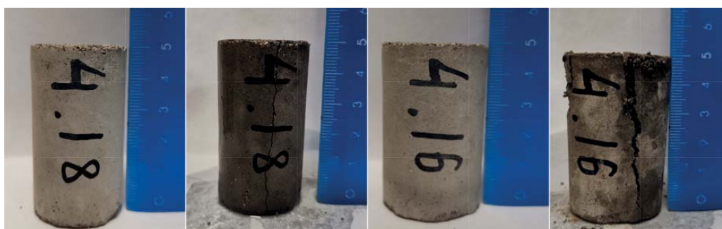
Рис. 6. Фото искусственных образцов зерна до и после экспериментов: разрыв маслом ГРП (слева), разрыв БС (справа).
